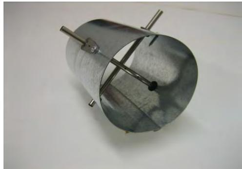
Abb. 1 (Zwei) Stausonde/ Messkreuz in Kanalstück eingebaut
